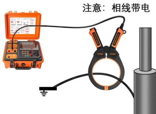
图 5-17 运行电缆卡钳耦合法 2（卡电缆接地线）
