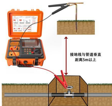
图 5-3 金属管道直连接线图
